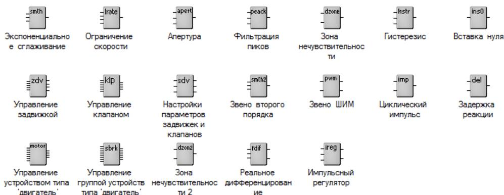
Рис. 110. Типовые функциональные блоки в составе SCADA-пакета TRACE MODE для реализации алгоритмов управления
