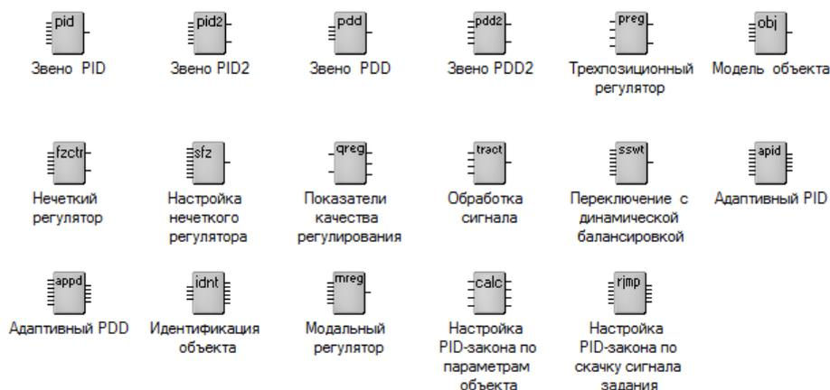
Рис. 109. Типовые функциональные блоки в составе SCADA-пакета TRACE MODE для реализации алгоритмов регулирования
