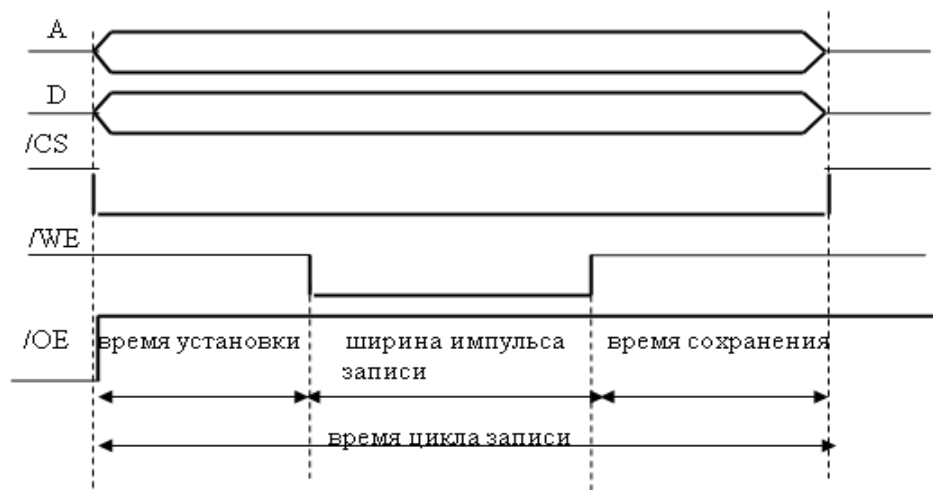
Рис. 1.8 . Временная диаграмма цикла записи статического ОЗУ
